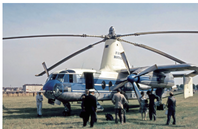
图19 英国Fairet航空公司“ROTODYNE”复合式旋翼机 Fig.19 The British Fairet Airlines “RORODYNE” compound rotorcraft
